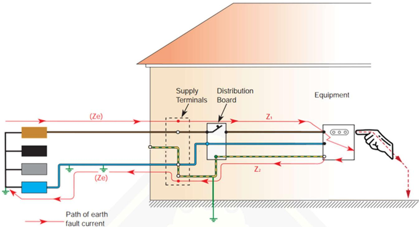
**تشریح حادثه:** فرض بر این است که اتصالی فاز به بدن ماشین لباسشویی در طبقه ششم ساختمان در فصل گرم به وجود آمده و سطح مقطع هادی فاز 2.5 میلیمتر مربع و سطح مقطع هادی حفاظتی 1.5 میلیمتر مربع است. امپدانس حلقه اتصال کوتاه اندازه گیری شده در فصل سرد در ورودی ساختمان برابر با 0.5 آهم و آرایش شبکه توزیع TNC-S است. طول مسیر از تابلو کنتور تا محل اتصالی در طبقه ششم ساختمان 35 متر است. نوع حفاظت در محل تابلو کنتور کلید مینیاتوری C25 و در تابلو واحد C16 است.
