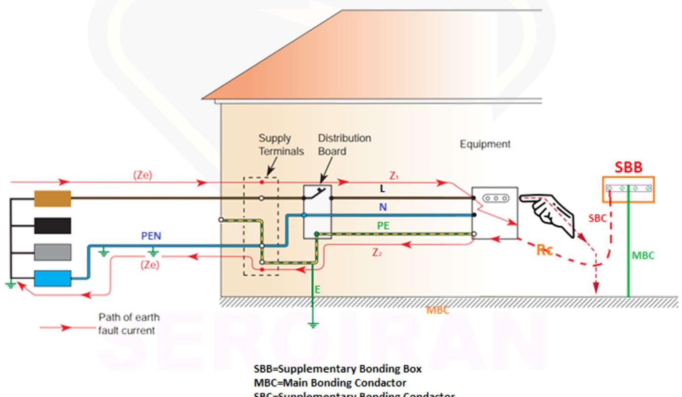
با اتصال هادی فاز به بدن کلید مینیاتوری تابلو واحد چون ۱۶ آمپر جریان نیاز دارد
