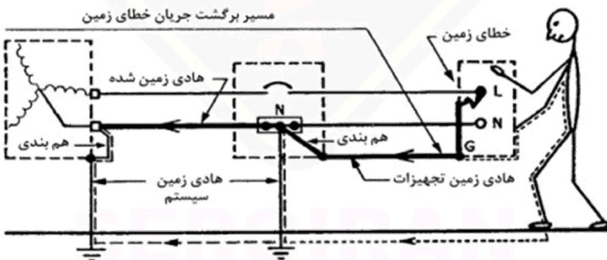
در شکل زیر تصویر ساده‌ای از یک شبکه توزیع نیروی برق فشار ضعیف با آرایش S-TNC می‌بینید که دارای الکترود زمین بوده و با توجه به مطالب قبلی ضرورت اتصال همبندی اصلی در آن رعایت شده که در شکل یک اتصال فاز به بدن نیز به وجود آمده و با توجه به فاصله زیاد هادی حفاظتی تا شینه همبندی تابلو کنتور به بررسی مداری و ولتاژ های تماس دستگاه ها می پردازیم.
